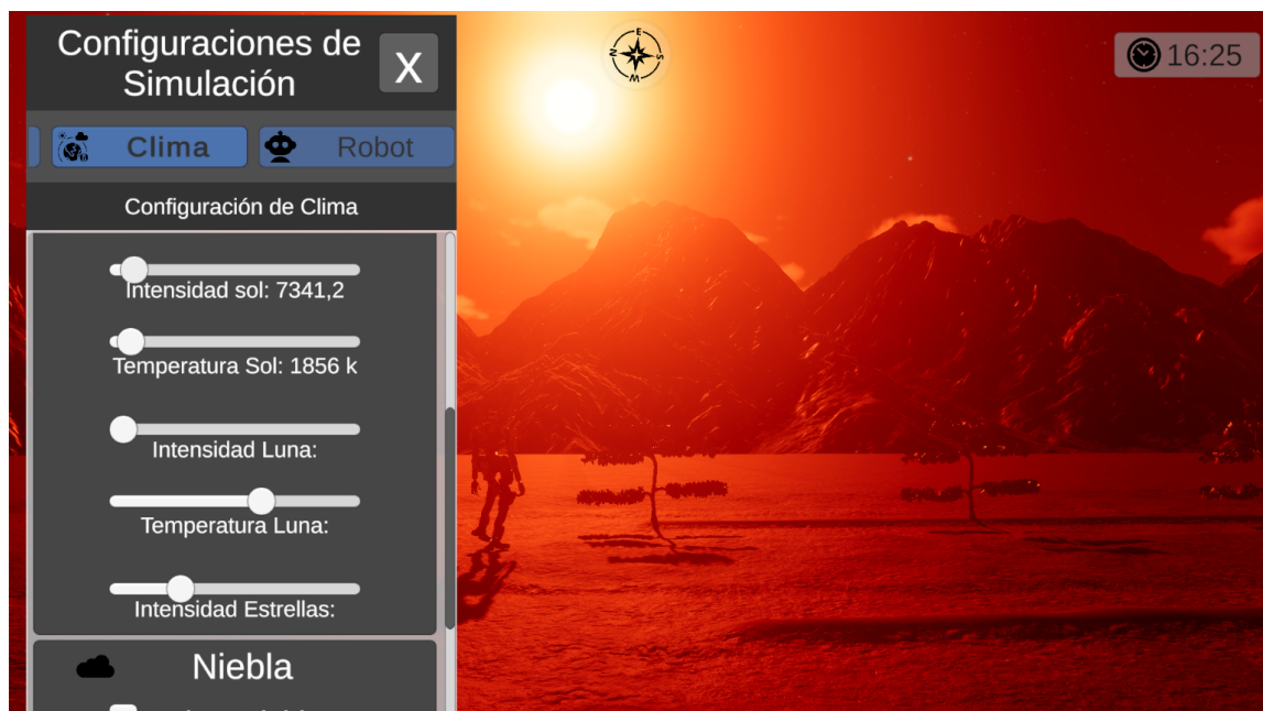
Figura B.15: Condición no nominal del entorno bajo una configuración extrema de iluminación: se modificaron deliberadamente la temperatura de color e intensidades del Sol.
